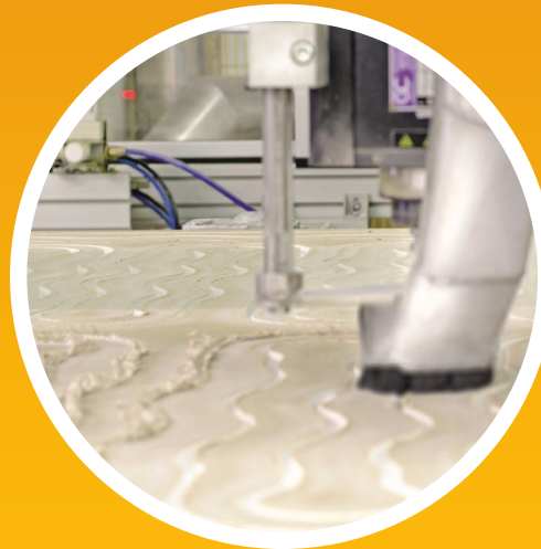
Fresatura del cartongesso
